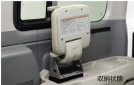
大きな車いす3脚を乗せる場合に、3列目の補助席を取りはずして反対側に移動して収納できます。
