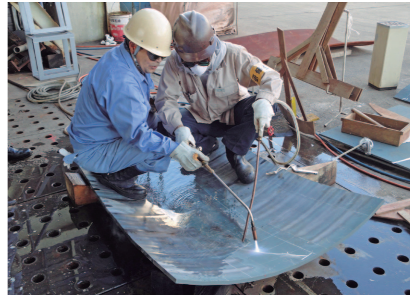
熟練者が他社の職員にも撓鉄研修で職人技を教えている[広島県尾道市、2011年10月]
